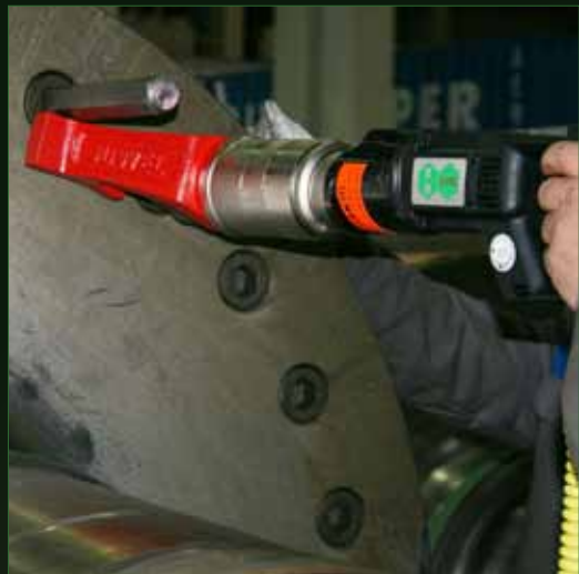
Frei drehbarer Sicherheitshandgriff für reaktionskraftfreie Bedienung beim Verschrauben
